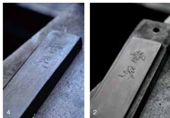
1/木枠に適量の墨玉をはめる。 2/反転して陽刻された蓋をかぶせ、万力で圧をかける。 3/型から出したらバリを取り除いて整形する。 4/陰刻の文字が浮かび上がった状態。型を自作できるとイメージした通りの墨ができるようになる。
