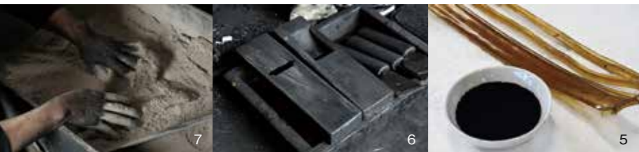
5/原料の煤(スス)と膠(ニカワ)。ニカワを湯煎で溶かしススと合わせる。 6/黒く染まった道具類。木型には加工しやすく反らないナシの木がいいとされる。 7/木型から出した墨は藁灰の中で湿気が除かれる。
